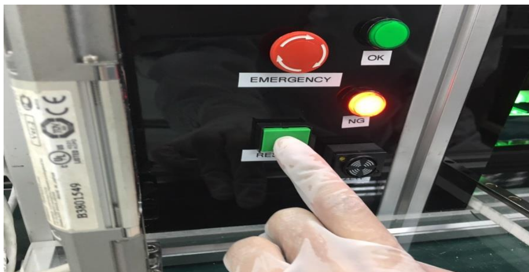
ภาพ ค-9 ถ้าชิ้นงานไม่ผ่านเงื่อนไขต้องกดปุ่ม Reset เพื่อให้เครื่องเลื่อนชิ้นงานออกมา
