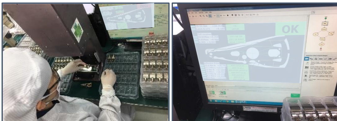
ภาพ 4.1 การตรวจวัดชิ้นงานด้วยเครื่องตรวจสอบตำแหน่ง (Vision) และหน้าจอแสดงผล
