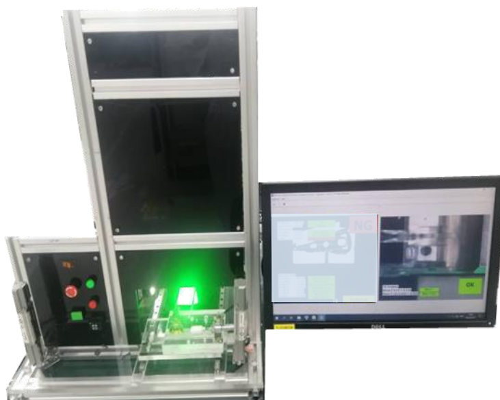
ภาพ 4.23 เครื่องวัดขนาดแขนหัวอ่าน-เขียนฮาร์ดดิสก์ New Vision Inspection Machine
