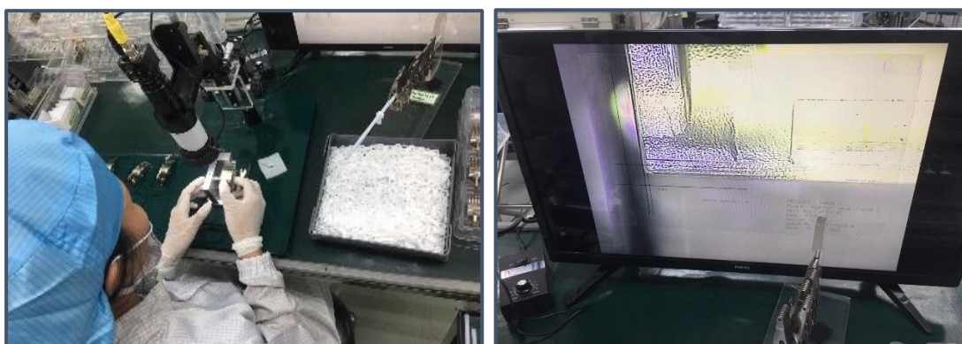
ภาพ 4.3 การตรวจสอบชิ้นงานด้วยกล้อง (CCD Camera) และหน้าจอแสดงผล
